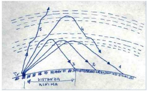
La riflessione totale di un'onda a radiofrequenza, da parte dello strato ionizzato, dipende oltre che dalla frequenza del segnale, dalla densità di ionizzazione degli strati atmosferici e dall'angolo di incidenza nella ionosfera.
