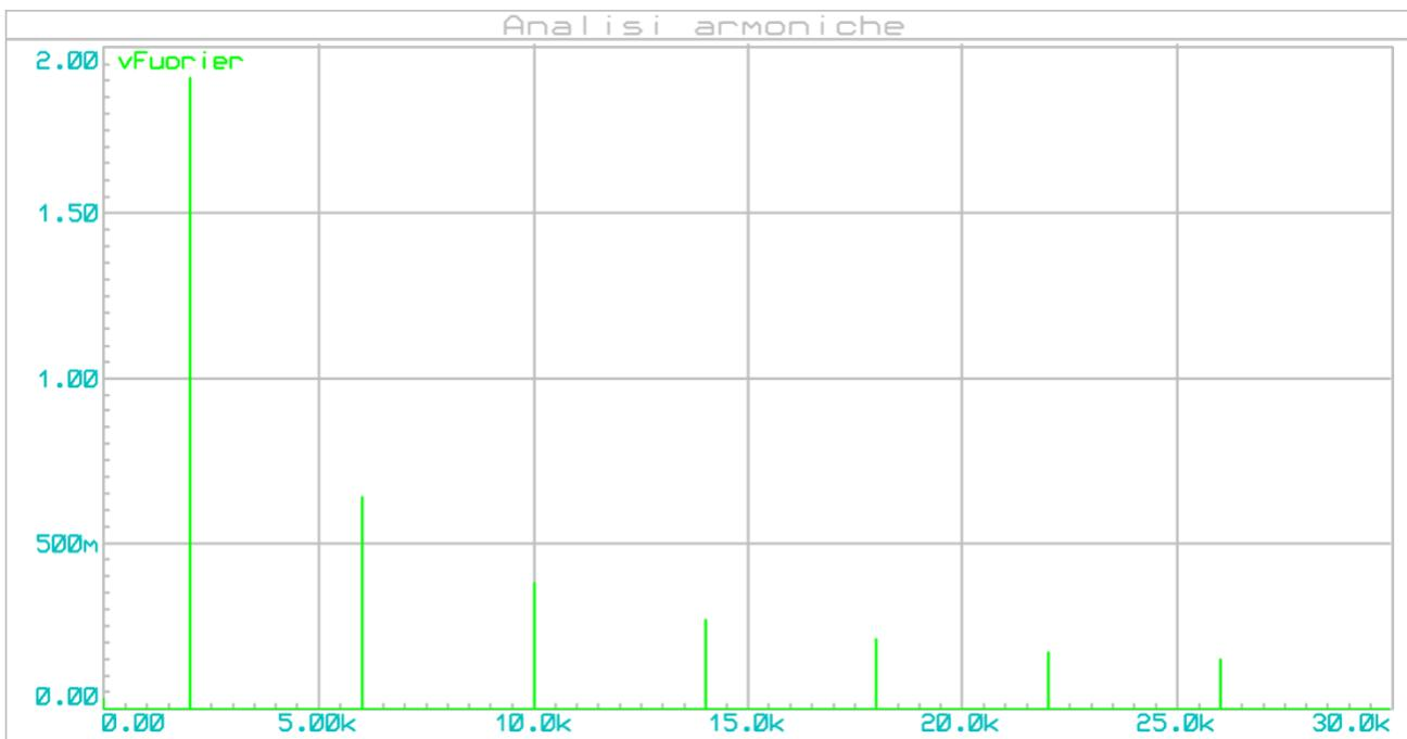
Spettro di Fourier delle componenti armoniche dell'onda quadra dispari ottenuta (NB: uguale allo spettro dell'onda quadra pari simulata in precedenza, dal momento che viene calcolato il modulo di ogni singola componente)
