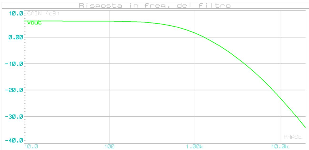
Risposta in frequenza del filtro di 2° Ordine (con  $f_t=4[\text{KHz}]$ )
