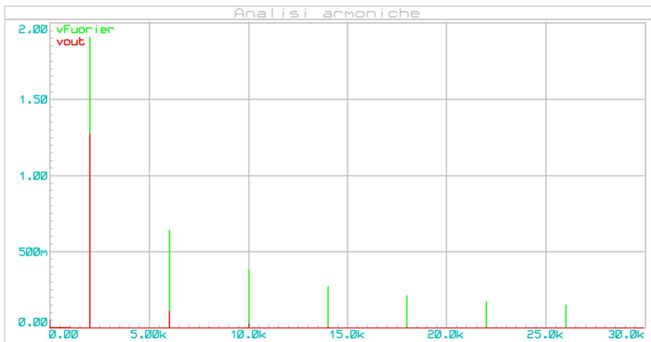
Analisi delle armoniche dell'onda filtrata a 2[KHz]. Possiamo notare che esiste ancora una piccola parte di segnale a 6[KHz] e 10[KHz], difatti nel dominio del tempo non otteniamo un'onda perfettamente sinusoidale, ma bensì un onda distorta.
