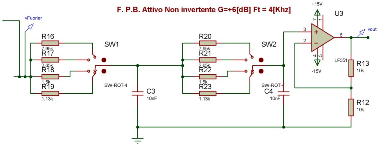
Ruotando assieme i due rotary switch, è possibile scegliere le varie frequenze di taglio del filtro (rispettivamente 2[KHz], 6[KHz], 10[KHz], 14[KHz]).
