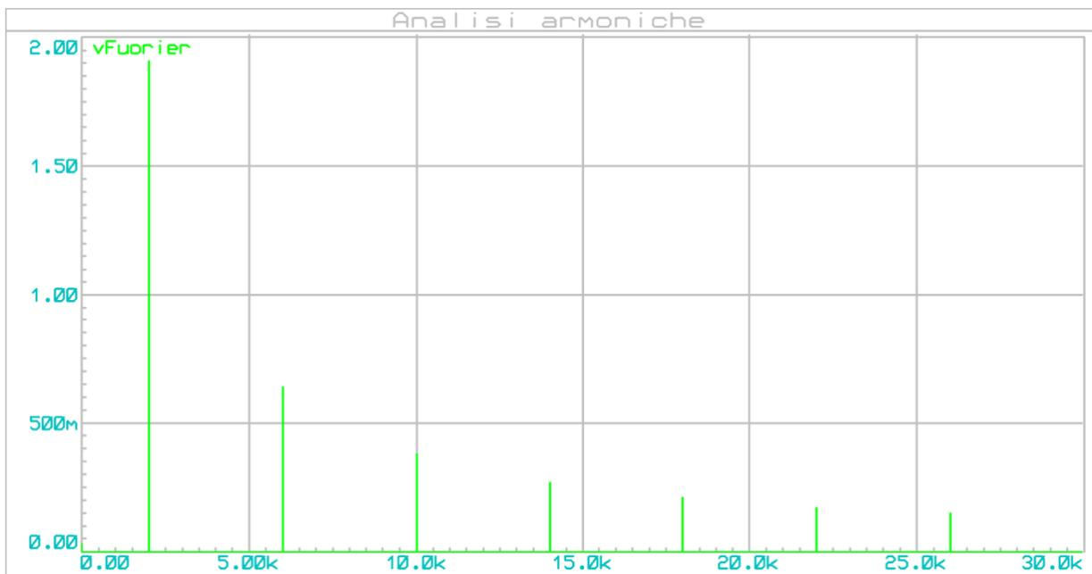
Spettro di Fourier dell'onda quadra ottenuta
