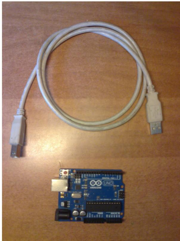
Il collegamento di arduino al PC viene effettuato mediante cavo USB-A <-> USB-B, non incluso nelle confezioni di Arduino tranne che negli Starter Kit
