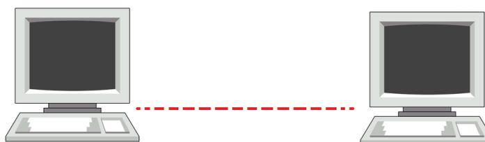
Null-modem è una connessione molto utilizzata ancora oggi, seppur limitata nelle prestazioni - pochi kbps. Nella versione minimale richiede solo 3 fili, e questo è il vantaggio principale. E' utile per comunicazioni che richiedono scambio di dati limitato, a bassa velocità; classico utilizzo è la comunicazione di caratteri tra due DTE.
