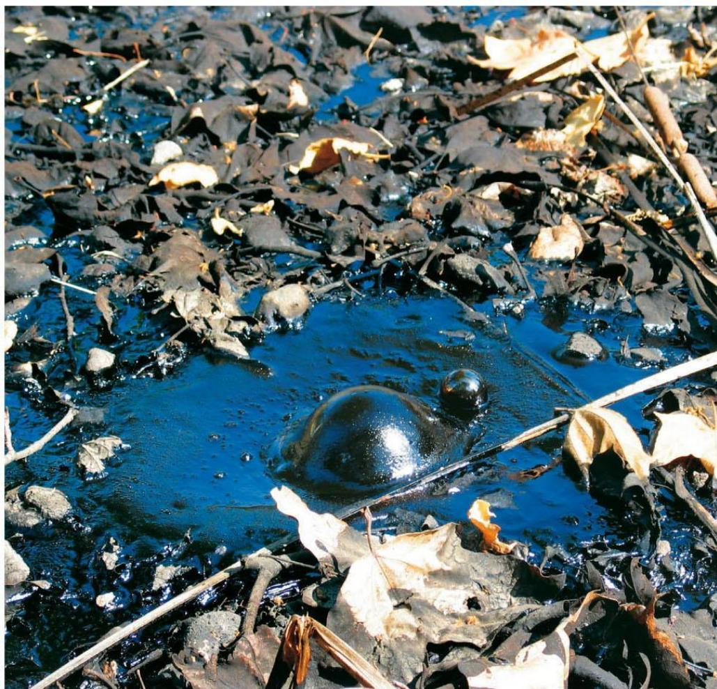
Il **bitume** è una miscela di idrocarburi naturali o derivanti dalla distillazione del petrolio greggio. Il bitume, che viene utilizzato soprattutto per le pavimentazioni stradali, è costituito principalmente da carbonio e idrogeno ed è considerato un composto organico.
