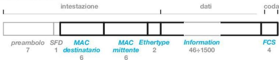
Entrambi i pacchetti rispettano uno dei parametri progettuali di Ethernet, ovvero che il pacchetto più corto circolante in rete non sia inferiore a **64 ottetti** (byte), esclusi *preambolo* e *SFD*. In totale un frame Ethernet non può essere inferiore a **72 byte** (576 bit).
