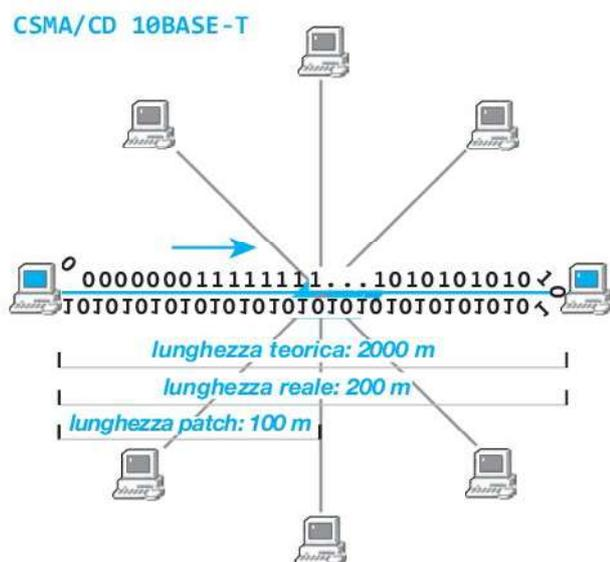
In ogni caso la scelta di un pacchetto minimo di 72 byte (64+8 di preambolo e SFD) consente a 10BASE5/10BASE-T di ottenere un dimensionamento fisico soddisfacente per una LAN. Tale parametro rimarrà inalterato per molti anni.
