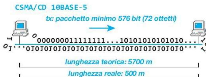
Infine, siccome l'attenuazione del segnale su cavo coassiale vale un fattore 10, la massima tratta di bus ammissibile per rilevare correttamente le collisioni si riduce a circa 500 m.
