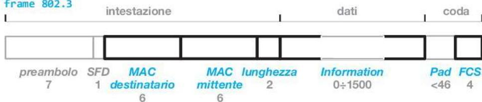
Per questo motivo, dato che la parte costante di entrambi i pacchetti vale 18 ottetti (6+6+2+4), se la parte *dati* è inferiore a 46 (64-18), il MAC la «riempie» automaticamente con tanti byte a zero fino a raggiungere 64 ottetti totali. Inoltre un pacchetto Ethernet (sia Ethernet 2 che 802.3) non può mai superare 1518 byte di ampiezza, altro limite progettuale del protocollo originale dovuto all'**MTU di Ethernet** che vale **1500 ottetti** per il campo *dati*.
