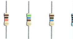
**Resistenze** - Resistono al flusso di energia elettrica in un circuito modificando di conseguenza la tensione e la corrente. I valori di resistenza sono misurati in Ohm (rappresentata dal carattere greco omega,  $\Omega$ ). Le strisce colorate delle resistenze indicano il loro valore (vedi tabella colori delle resistenze, a pagina 41).
