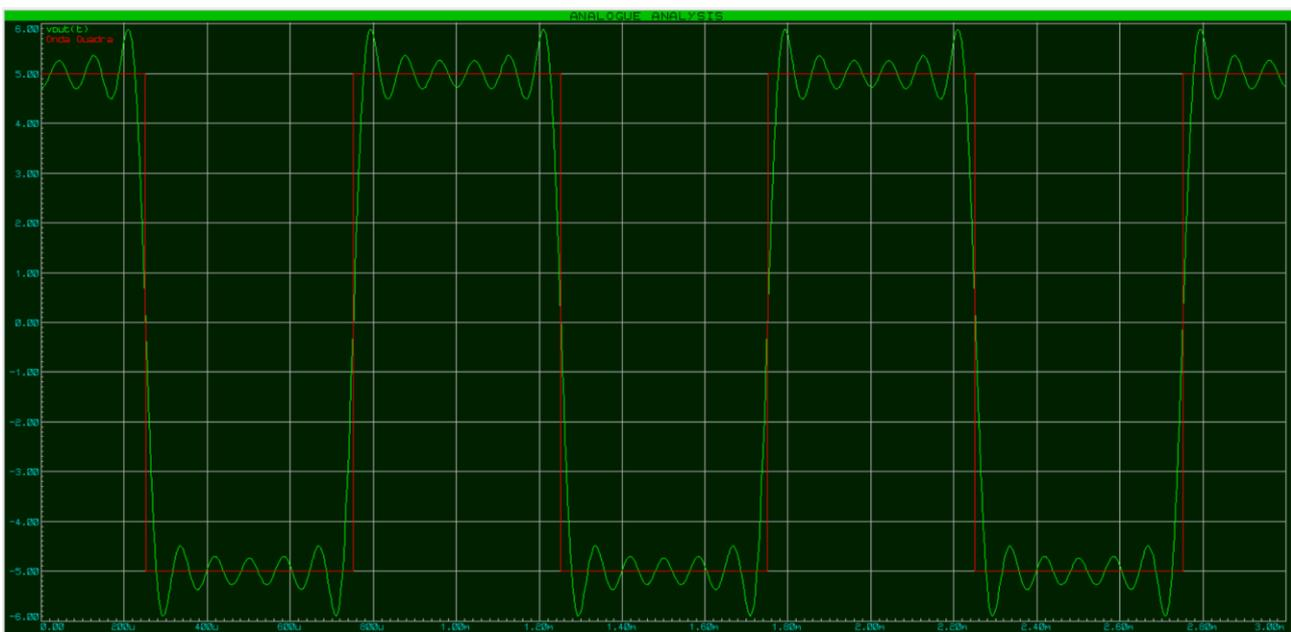
Nel circuito con sette tensioni d'ingresso vediamo che la  $v_{out}(t)$  è molto simile alla nostra onda quadra, però notiamo ancora la pendenza della salita e della discesa e le oscillazioni intorno a +5 [V] e -5[V].
