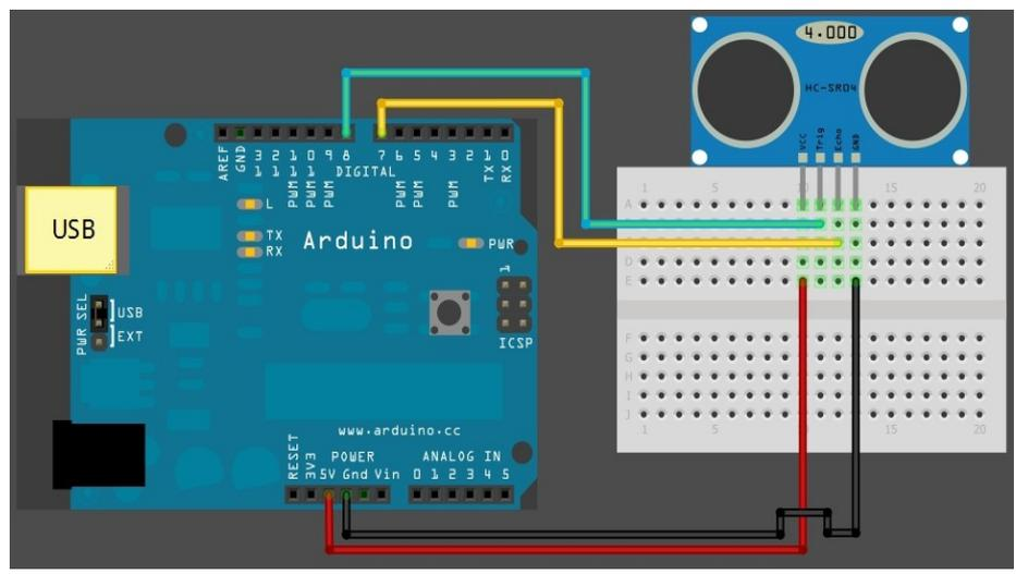
Per convertire l'intervallo di tempo misurato in una lunghezza, bisogna ricordare che la velocità del suono in aria è di 331,5 m/s a 0 °C e di 343,4 m/s a 20 °C ed in generale varia secondo la relazione
