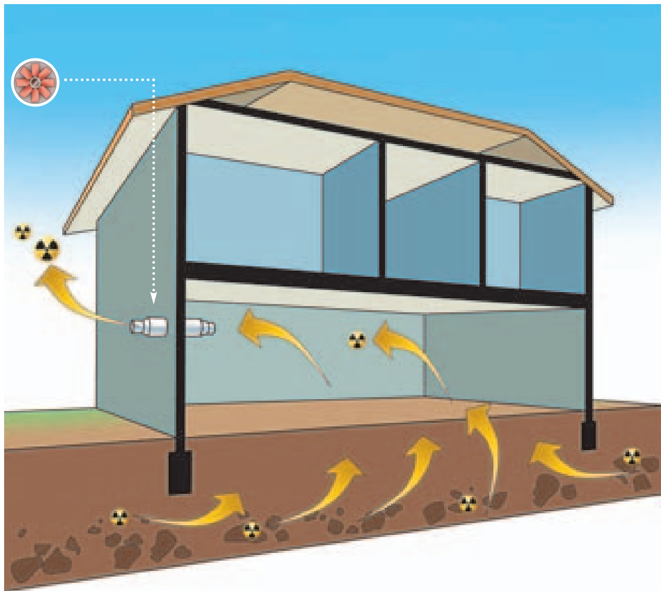
Figura 4.1b. Abbattimento attivo del radon in un'abitazione. Il ventilatore instaura una depressione nel locale favorendo il richiamo di aria ricca di radon e la sua concomitante espulsione.
