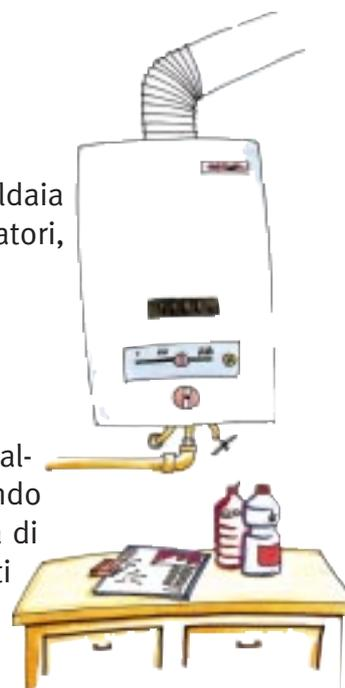
Controllare periodicamente lo stato delle canne fumarie metalliche soprattutto nel punto di innesto nel muro verificando che non ci siano annerimenti. L'annerimento è conseguenza di un cattivo tiraggio e di una emissione di fumi contenenti ossido di carbonio e anidride carbonica.
