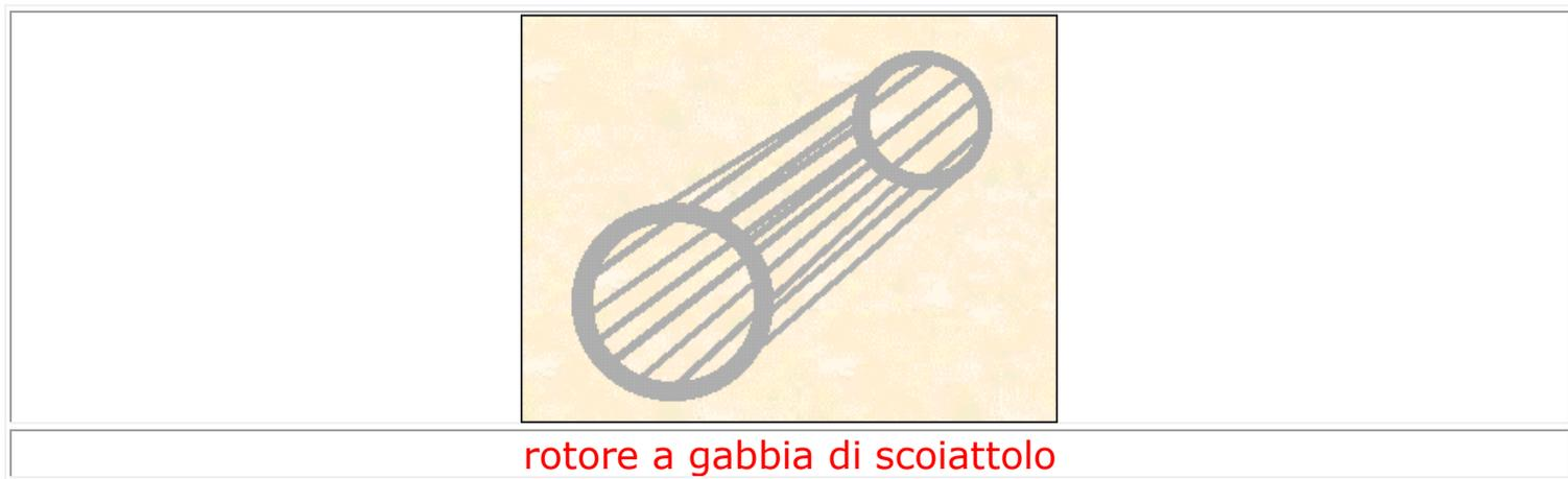
Poiché gli avvolgimenti da fare sul rotore devono essere in corto circuito e devono, quindi, sopportare una elevata corrente, devono avere una elevata sezione, per cui si preferisce mettere delle barre di alluminio attorno ad un nucleo di materiale ferromagnetico, costituito da lamierini al silicio.
