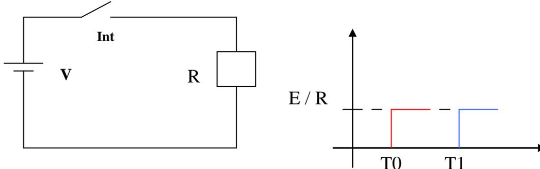
Supponiamo di chiudere l'interruttore nell'istante  $T_0$  e la corrente, quasi istantaneamente passa da 0 al valore  $E / R$ . Se la resistenza  $R$  viene alimentata nell'istante  $T_1$ , diverso da  $T_0$ , la corrente comunque si porta allo stesso valore  $E / R$ .
