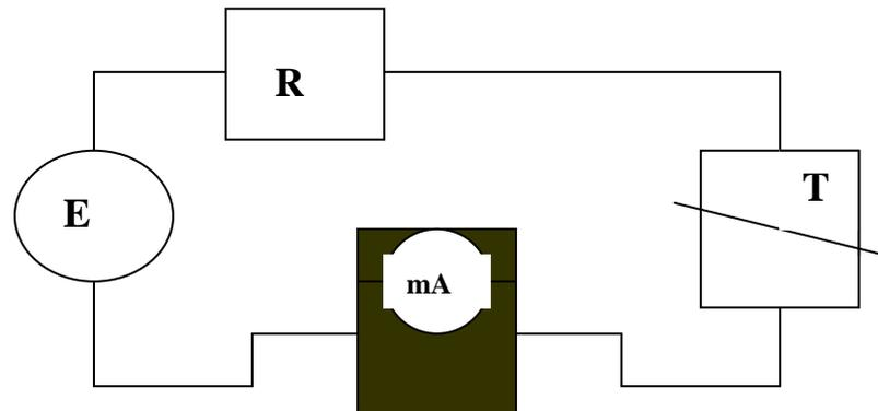
Nella figura stessa E indica un alimentatore in continua e T indica un termistore.
