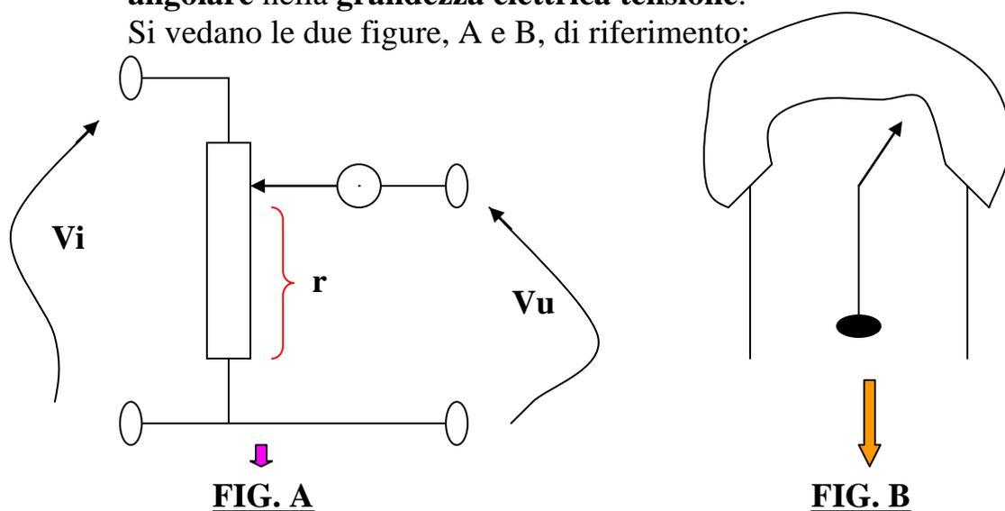
La figura A rappresenta un trasduttore lineare, la figura B un trasduttore angolare.
