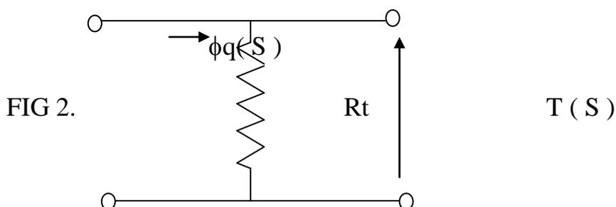
**La rappresentazione del sistema TERMICO con un circuito elettrico è detta ANALOGIA.**
