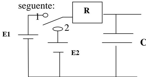
La carica del sistema ( il condensatore ), dipende dalla tensione applicata, ma anche dalle sua carica iniziale. Quando l'interruttore è nella posizione 1, il condensatore C si carica relativamente al valore E1; se il tasto viene spostato nella posizione 2, noi sappiamo che l'andamento della tensione ai capi del condensatore C dipende dal rapporto tra E1 ( condizione iniziale ), ed E2 ( nuova sollecitazione ): in pratica la carica del condensatore dipende dal valore assunto precedentemente.
