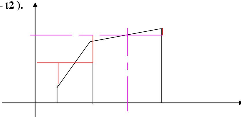
**Estendendo il ragionamento a tutto l'intervallo  $[ t_1, t_3 ]$ , si può quindi dire che il valore medio di  $v = v(t)$  è pari a  $V_m$ , altezza del rettangolo, con base  $t_3 - t_1$ , ed è uguale all'area del pentagono  $ABCt_3t_1$ .**
