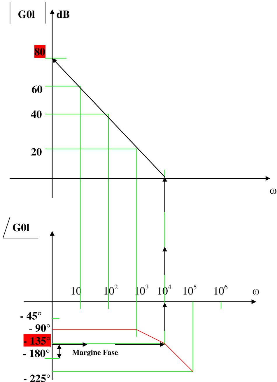
Considerando il margine di fase di  $45^\circ$ , in corrispondenza della fase di  $-135^\circ$ , corrisponde una pulsazione di  $10.000$  rad / s, corrispondente alla pulsazione del secondo polo della  $G_{01}$ . Proprio in corrispondenza di detta pulsazione si vuole che il diagramma del modulo tagli l'asse delle pulsazioni. Partendo dal grafico del modulo dalla pulsazione di  $10.000$  rad / s, proseguendo a ritroso con una pendenza di  $20$  dB / decade, si giunge al primo polo, ( polo
