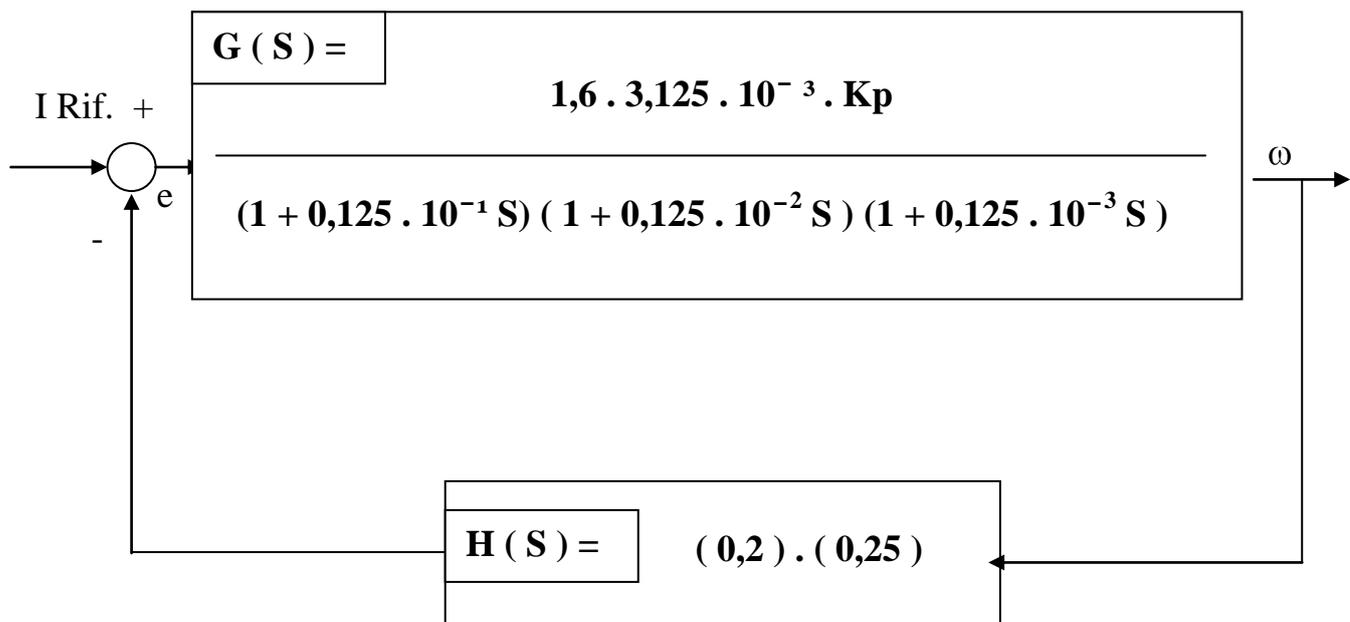
Ricordando, infine che la funzione di trasferimento complessiva o totale di un sistema in retroazione, con reazione negativa, è :
