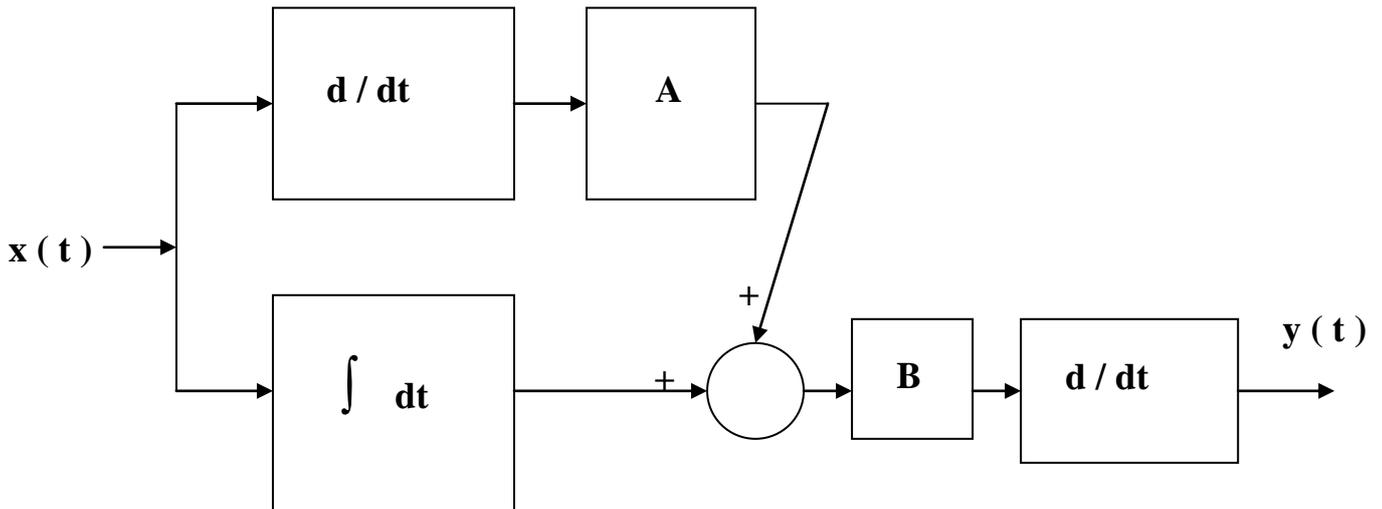
Si può procedere semplificando il sistema dato, essendo costituito dal parallelo di due blocchi potremo scrivere: ( Si tenga conto che il ramo superiore prevede la serie di due blocchi, come anche la parte destra del nodo sommatore )
