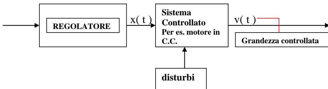
Alcuni sistemi da controllare necessitano di una potenza elevata che, il regolatore non è in grado di erogare, si ricorre allora ad un **AMPLIFICATORE di POTENZA**, detto **ATTUATORE**. Il suo compito è di amplificare la potenza fornita dal regolatore rendendola, così adatta a pilotare il sistema.
