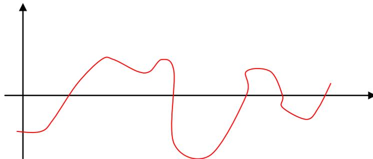
**Nel caso di un segnale BIDIREZIONALE, il valore medio si ottiene calcolando l'area sottesa della curva come SOMMA ALGEBRICA delle aree sottese dalla curva superiormente ed inferiormente all'asse x.**
