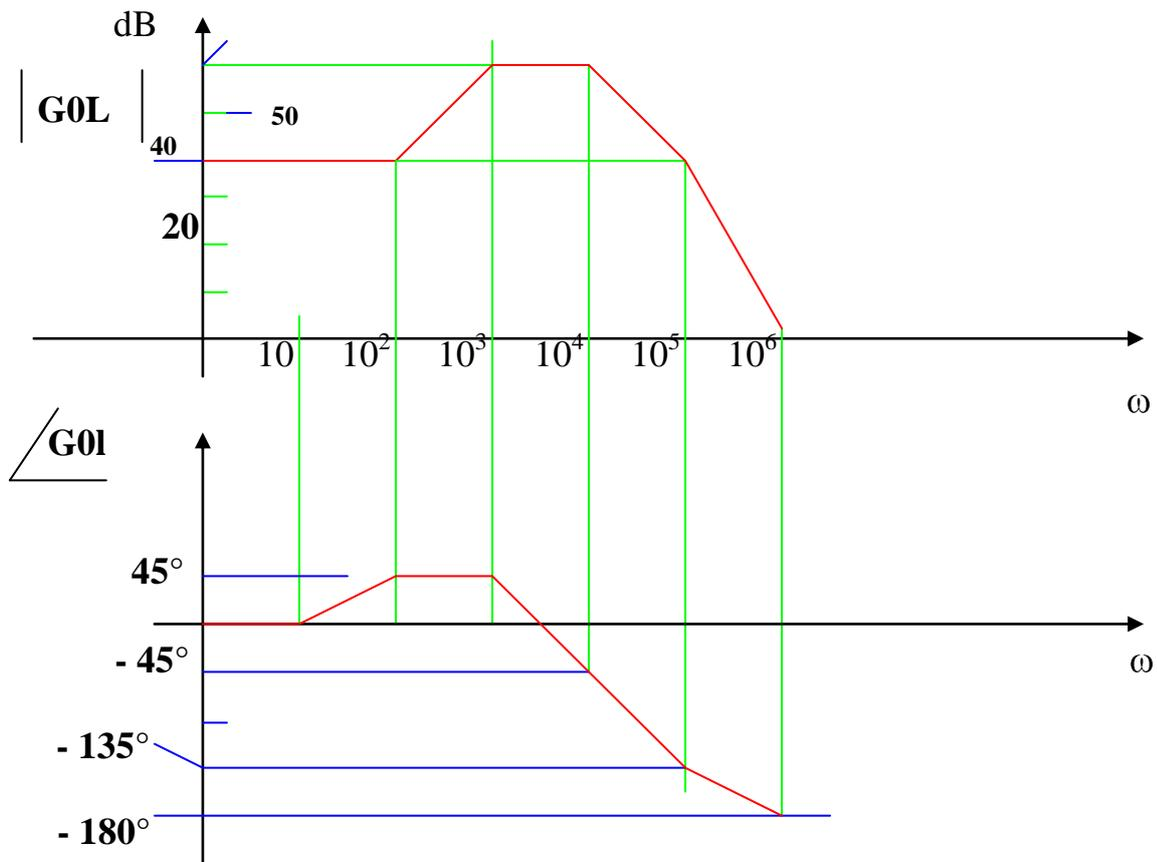
Il sistema risulta instabile, perché siamo al limite della stabilità; infatti quando il diagramma del modulo taglia l'asse delle  $\omega$ , il diagramma della fase assume una fase di  $-180^\circ$ .
