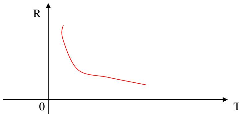
Vengono realizzati con ossidi di nichel, manganese ed altri elementi che assumono, dopo i vari trattamenti, un aspetto ceramico. Il suo funzionamento si può illustrare con il circuito di figura, che è un
