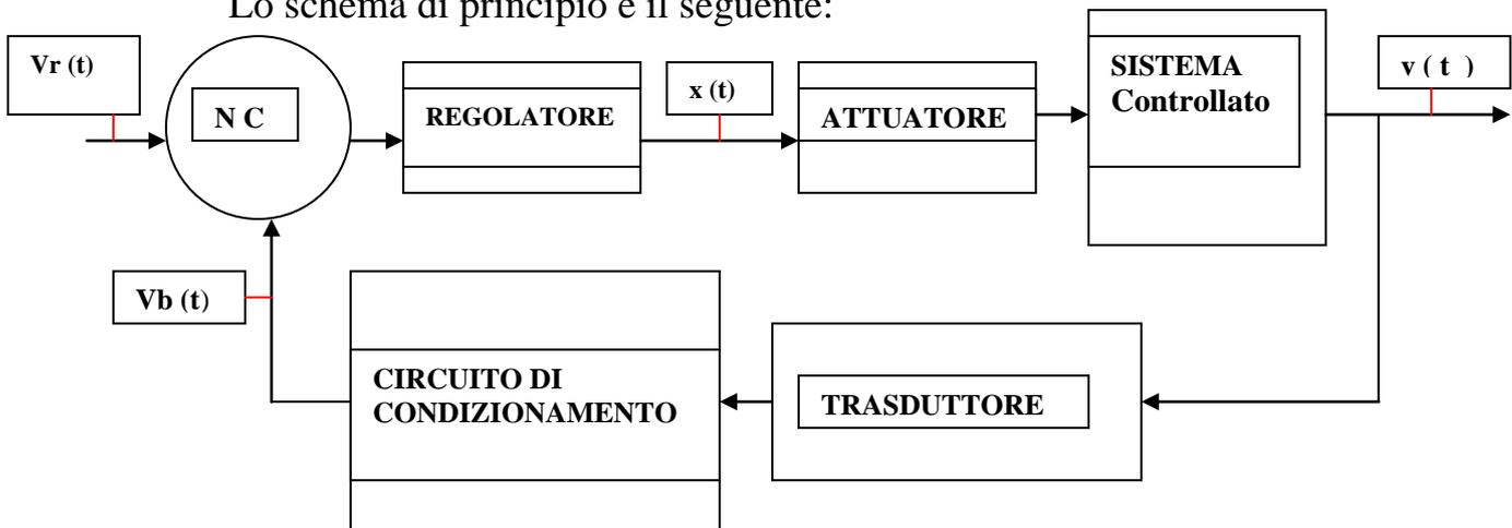
Dove  $V_r(t)$  è il segnale di riferimento, ossia il segnale elettrico che, rappresenta il valore desiderato della grandezza da controllare;  $V_b(t)$  è il segnale di uscita riportato in ingresso e rappresenta una misura della grandezza da controllare;
