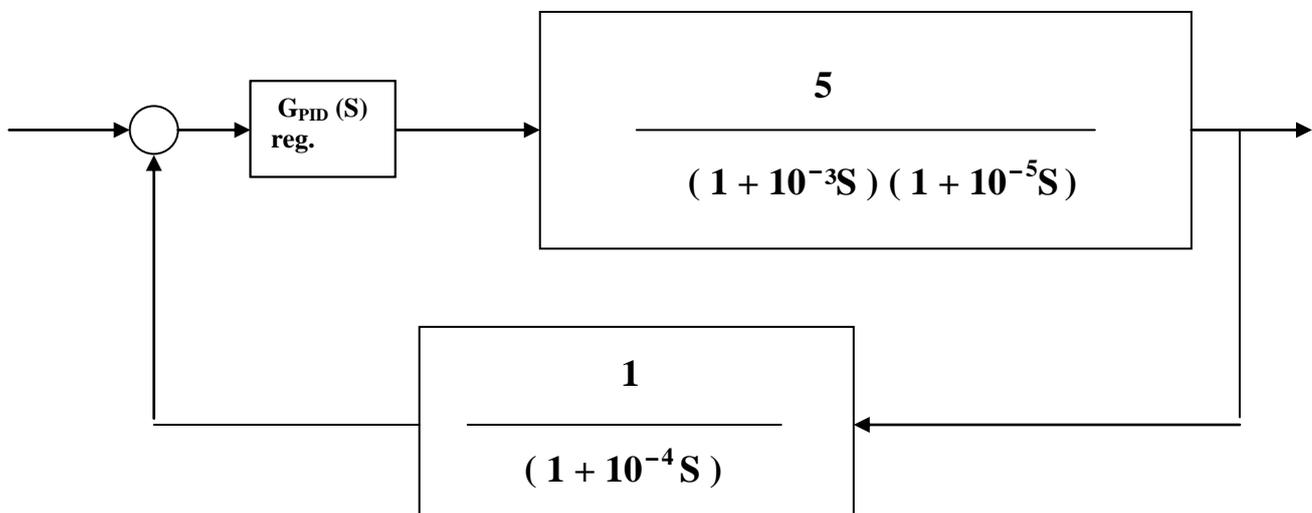
Questo tipo di regolatore, o il regolatore PID, presenta una funzione di trasferimento del tipo seguente:
