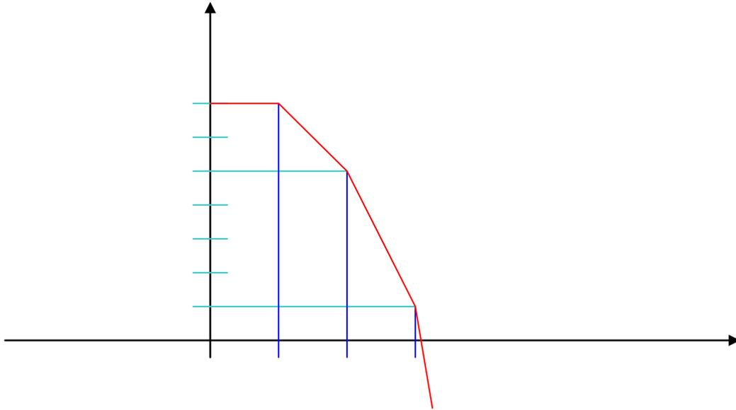
Rispetto al caso precedente il diagramma del modulo della  $G_0l$  taglia l'asse delle  $\omega$  con una pendenza di  $60 \text{ dB / decade}$ , pertanto per il criterio semplificato di Bode il sistema risulta certamente **INSTABILE**.
