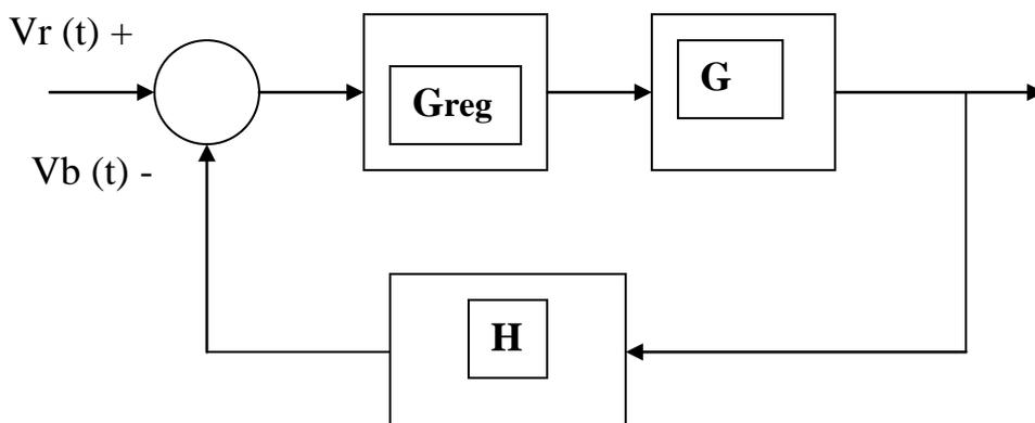
Esistono diversi tipi di regolatori, con caratteristiche di funzionamento e prestazioni diverse, ma ognuno di essi può essere inserito in un qualsiasi sistema di controllo; infatti alcuni parametri di essi sono variabili, in modo tale che possano essere adattati al sistema da controllare.
