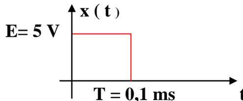
Ma il segnale dato non corrisponde ai segnali da noi visti, ossia non è né un gradino, né un'esponenziale e né un segnale periodico come quello sinusoidale, ecc. Comunque è possibile pensare il segnale in oggetto come una differenza fra un segnale a gradino ed un segnale a gradino traslato di un lasso di tempo  $T$ :
