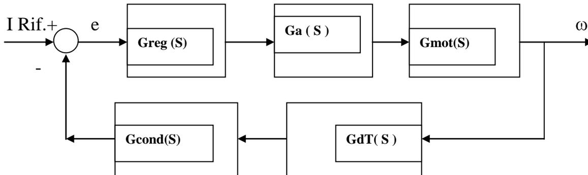
Dove  $G_{ref}(S)$  rappresenta la funzione di trasferimento del regolatore proporzionale o regolatore P, con  $G_a(S)$  funzione di trasferimento dell'attuatore, si intuisce la sua presenza dall'affermazione del testo: ... **il sistema di comando ha guadagno statico pari a 1,6 e una costante di tempo di 12,5 ms.**
