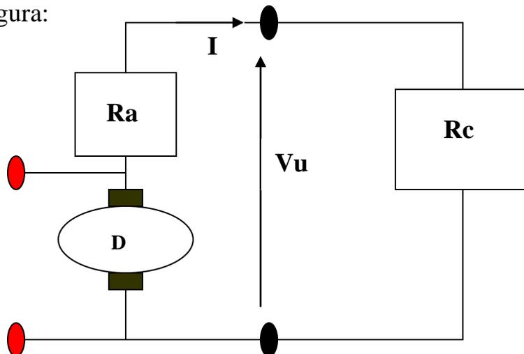
Nella figura,  $E$  rappresenta la forza elettromotrice a vuoto;  $R_a$  la resistenza degli avvolgimenti;  $R_c$  la resistenza del carico;  $V_u$  la tensione di uscita ed infine,  $I$  la corrente.
