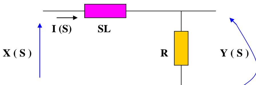
Pertanto ammettendo che:  $\mathcal{L} y(t) = Y(S)$ ;  $\mathcal{L} x(t) = X(S)$ ;  $\mathcal{L} i(t) = I(S)$  ed infine,  $\mathcal{L} (L di(t) / dt) = SL I(S)$ , dove con  $\mathcal{L}$  si è indicato l'operatore trasformata di LAPLACE.
