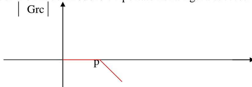
La scelta del polo deve essere effettuata in modo che l'attraversamento dell'asse delle ascisse, del diagramma di BODE del **modulo** di
