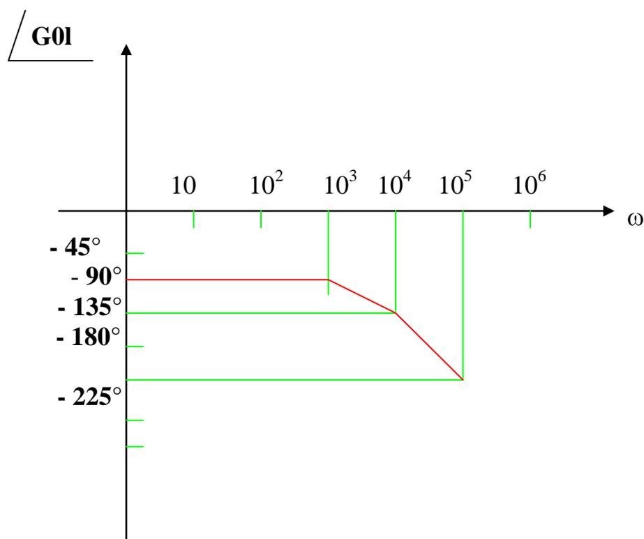
Per proseguire nella stessa linea adottata negli esercizi precedenti, riportiamo prima il diagramma del modulo della  $G_{01}$  e poi tracciamo, sotto di esso, il diagramma delle fasi ricavato nella pagina precedente. Graficamente si ottiene il valore di modulo che il regolatore deve fornire:
