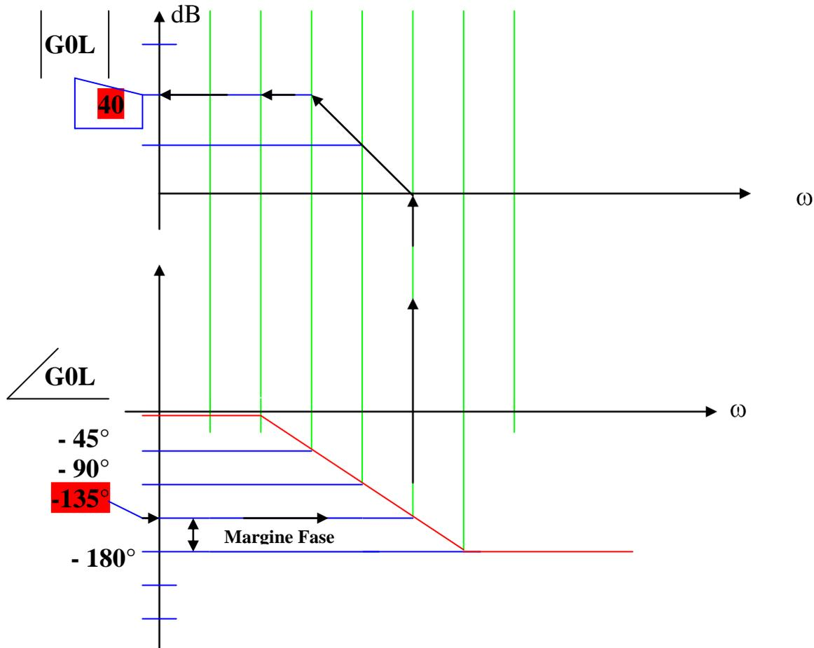
Come si capisce, il sistema è stabile se il diagramma di BODE del Modulo, taglia l'asse delle  $\omega$  nel punto corrispondente al secondo polo della **G0L**,
