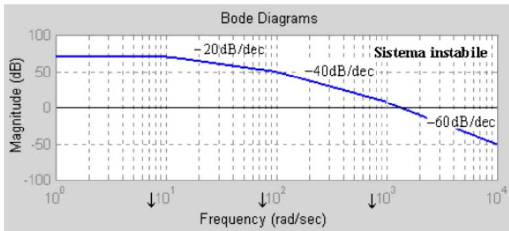
L'attraversamento dell'asse delle ascisse avviene con una pendenza di  $-60\text{dB/dec}$ , pertanto il sistema è instabile
