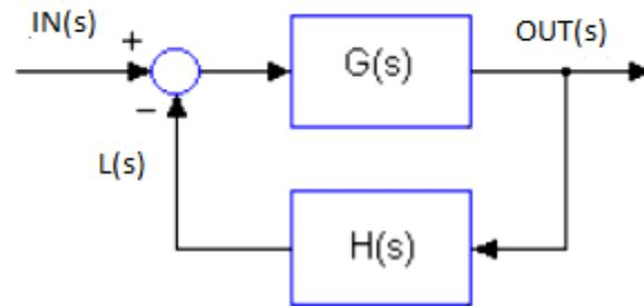
Il criterio di stabilità di Nyquist permette di determinare la stabilità del sistema ad anello chiuso. Esso si basa sul tracciamento del diagramma di Nyquist della funzione f.d.t. ad anello aperto cioè  $L(s) = G(s) \cdot H(s)$ . per  $\omega$  variabile da  $-\infty$  a  $+\infty$
