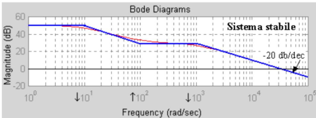
L'attraversamento dell'asse delle ascisse avviene con una pendenza di  $-20\text{dB/dec}$ , pertanto il sistema è stabile
