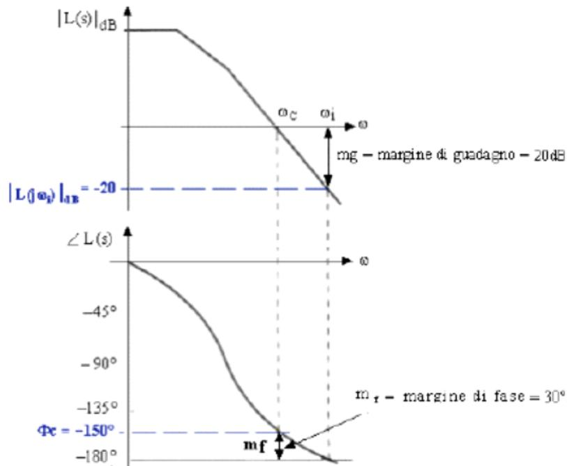
Il sistema è stabile in quanto in corrispondenza della pulsazione critica  $\omega_c$ , lo sfasamento in valore assoluto della f.d.t ad anello aperto è  $|\Phi_c| = 150^\circ < 180^\circ$ .
