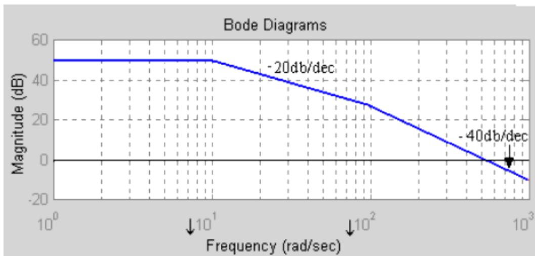
L'attraversamento dell'asse delle ascisse avviene con una pendenza di  $-40\text{dB/dec}$ , il criterio semplificato di Bode non ci permette di valutare la stabilità.
