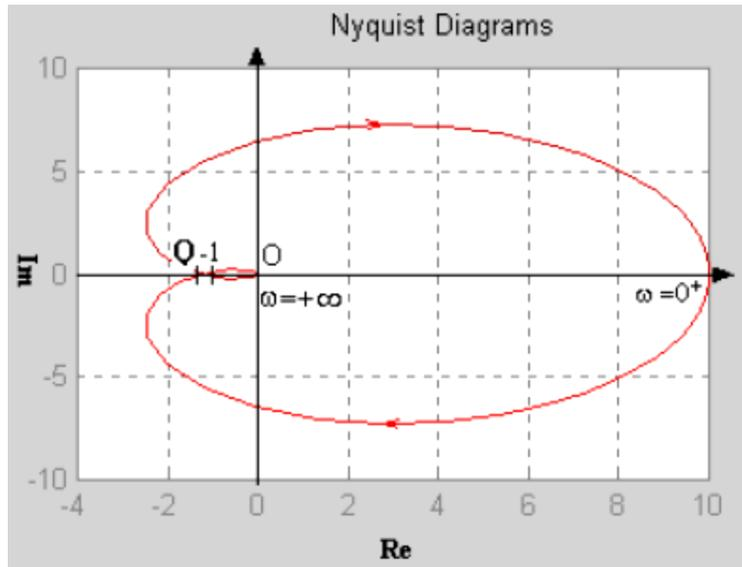
Calcoliamo il valore di  $\omega$  per cui il diagramma taglia l'asse Reale ( punto Q , avente fase  $180^\circ$ ) :
