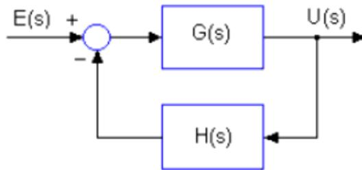
Il criterio di stabilità di Bode<sup>1</sup> permette di determinare la stabilità quando è nota la funzione f.d.t. ad anello aperto cioè la  $L(s) = G(s) \cdot H(s)$ .
