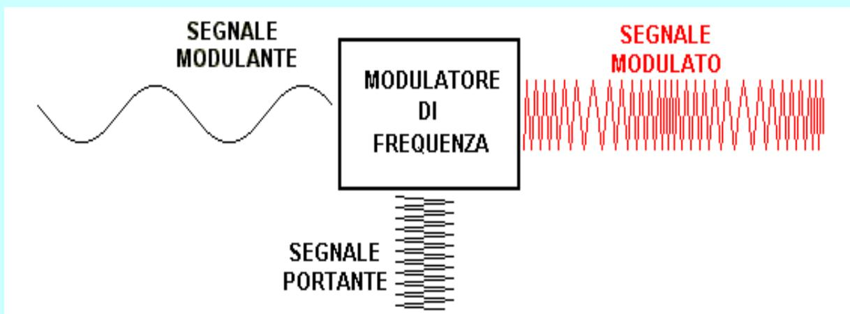
La modulazione di frequenza (FM) è applicata nel campo delle trasmissioni stereofoniche nella gamma delle **VHF**.
