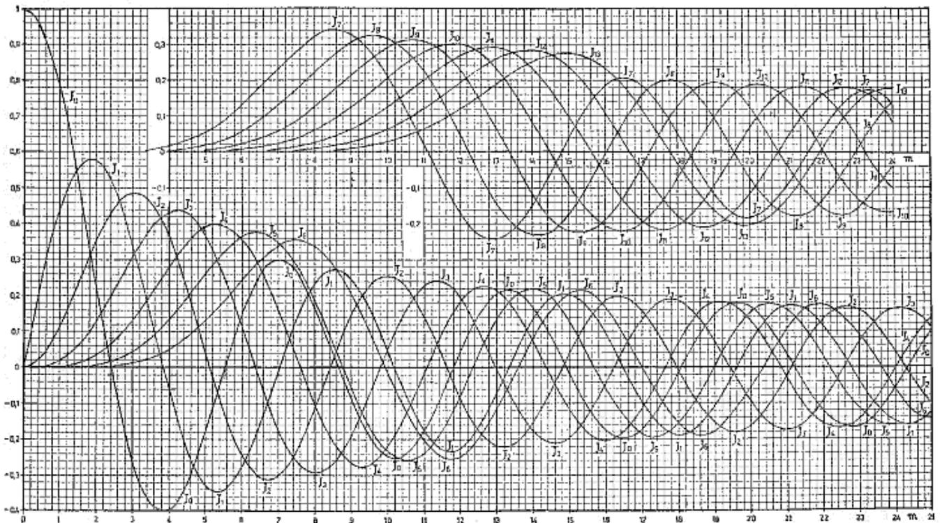
Sull'asse delle ascisse vi è l'indice di modulazione **m**, e sulle ordinate le funzioni di **Bessel** -
