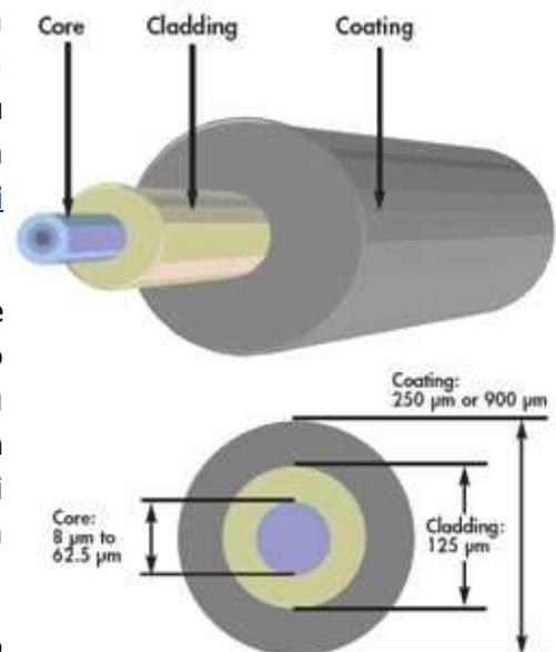
Al momento esistono **due differenti tipologie** di **fibra ottica**: la **fibra monomodale** e la **fibra multimodale**. In quest'ultima il segnale luminoso si propaga in diversi modi, seguendo cioè diverse traiettorie, il che permette una maggiore "portata", ovvero una maggiore potenza di segnale trasportato, rispetto alla sua controparte monomodale.
