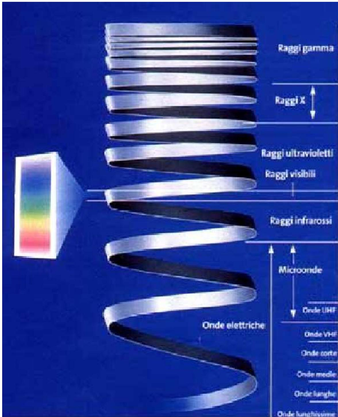
La classificazione delle onde elettromagnetiche fatta in base alla frequenza o alla lunghezza d'onda viene indicata col nome di
