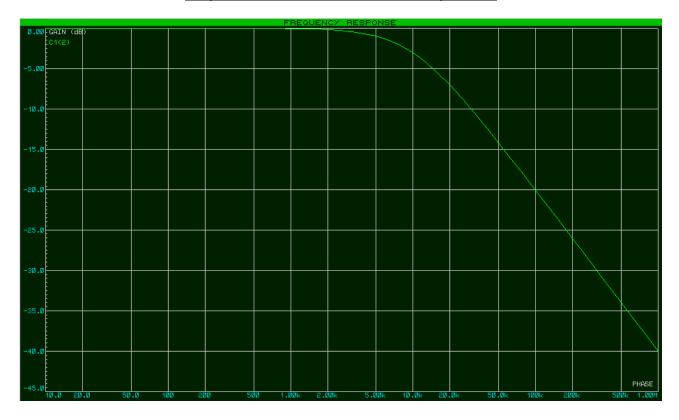
In questo grafico, il guadagno è espresso in [dB], ossia in unità logaritmiche. Il guadagno in [dB], noto il guadagno in scala lineare, è ricavabile mediante la formula
