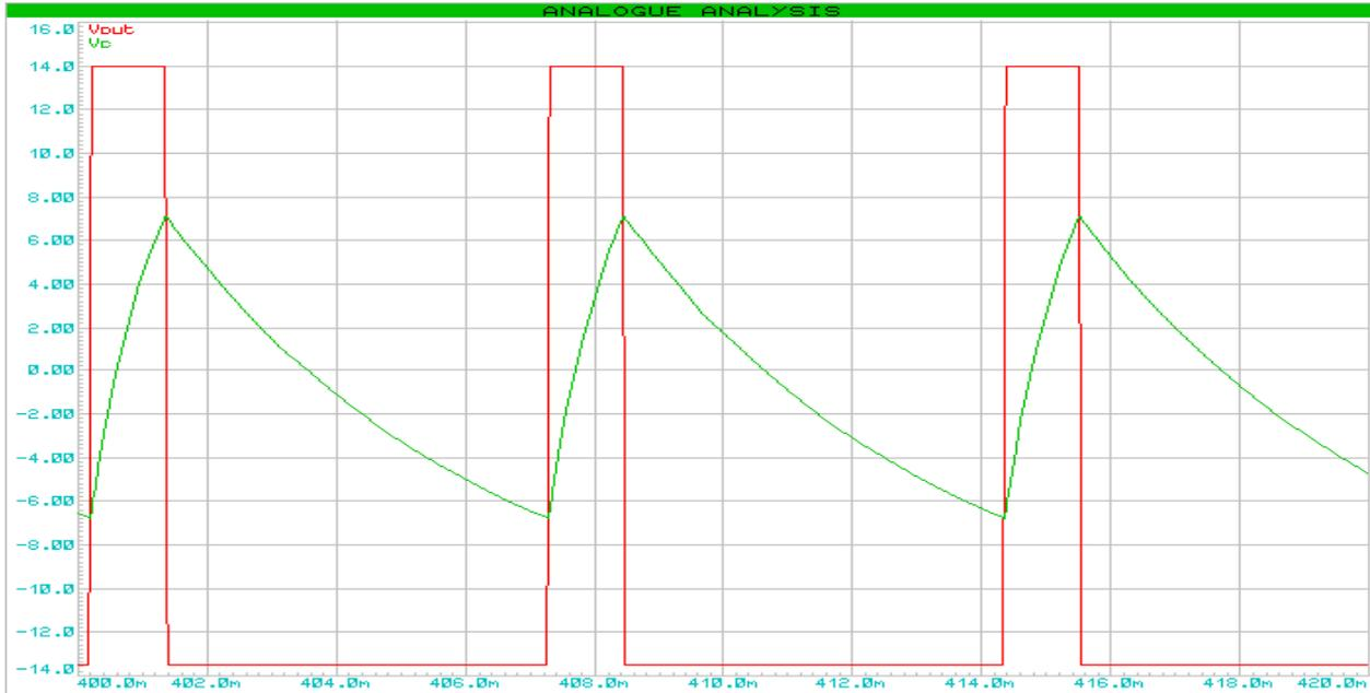
Se si vuole diminuire l'ampiezza del segnale d'uscita dell'operazionale si inseriscono in uscita, con in serie un'adeguata resistenza, due diodi zener, aventi la stessa "tensione di zener". La tensione di zener fissa l'ampiezza massima dell'onda d'uscita:
