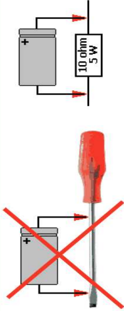
figura 6 - come va scaricato un condensatore
