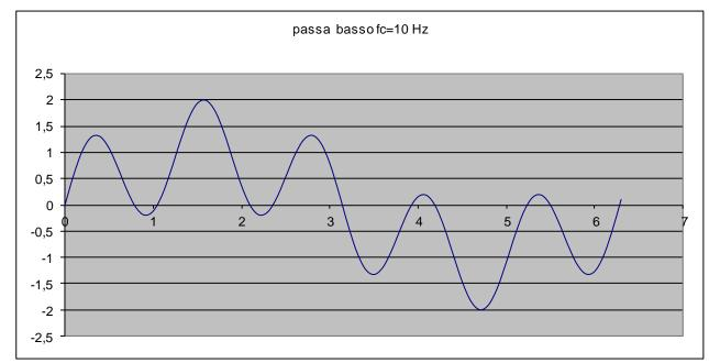
Filtraggio passa-basso (low-pass) : attenua tutte le armoniche a frequenza più alta della frequenza di taglio ( $f_c$  =10 Hz)
