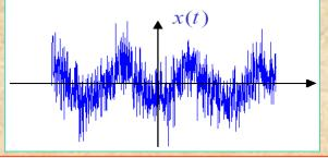
Un filtro **passa-basso** (*low-pass*) attenua tutte le armoniche a frequenza alta e lascia passare quelle **inferiori** alla frequenza di taglio (*cut frequency*).
