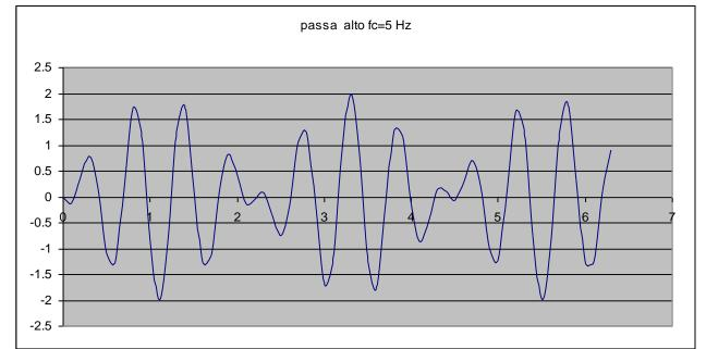
Filtraggio **passa-alto** (high-pass): "elimina" tutte le armoniche a frequenza più bassa della frequenza di taglio ( $f_c = 5 \text{ Hz}$ ).
