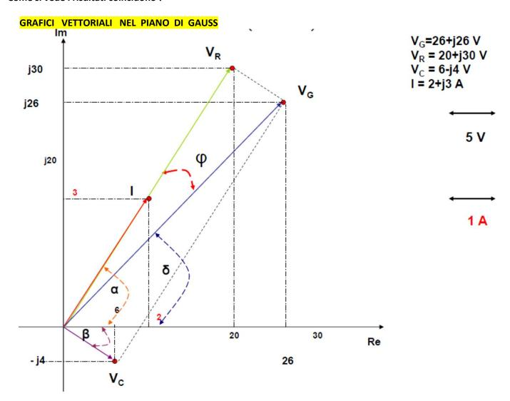
Dal grafico e dalle espressioni delle tensioni in forma polare si vede come i vettori  $V_R$  e  $V_C$  siano in quadratura e come sia rispettata la 2° Legge di Kirchhoff ( $V_G = V_R + V_C$ ), ma IN FORMA VETTORIALE!
