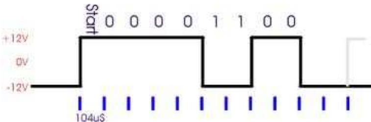
Segnale binario nello STANDARD RS 232 per la comunicazione seriale tra pc (a bassa velocità, inferiore a 112 [kbit / sec])
