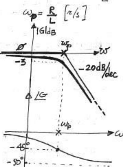
Il guadagno unitario (0 dB) in continua è provocato dall'impedenza  $\bar{Z}_L$ , nulla in d.c.. Perciò, per avere un'attenuazione in bassa frequenza bisogna fare in modo che non ci sia tale corto circuito: mettiamo una  $R_1$  in serie ad  $L$ .
