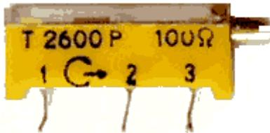
La resistenza RV che si trova nel circuito di base del transistor, è una resistenza variabile, detta anche **trimmer**. Nella pratica può avere l'aspetto di uno dei tipi che si vedono nella figura a sinistra; si tratta comunque di una resistenza il cui valore può essere regolato tra zero e il massimo (che è il valore indicato sulla resistenza stessa) facendo ruotare con un cacciavite un contatto strisciante che scorre su una superficie di materiale ad alta resistività.
