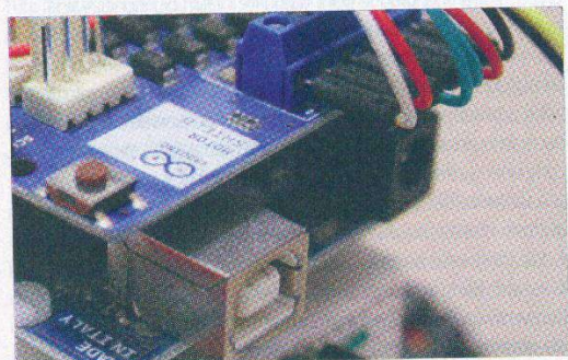
› Porta USB sulla scheda Arduino per la programmazione del firmware del prototipo
