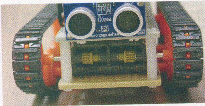
› Dettaglio degli ingranaggi per la trasmissione del moto dai motori ai cingoli
