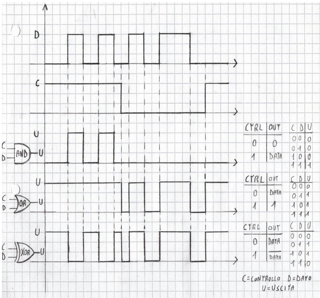
Nella prima "riga" possiamo osservare il dato preso come esempio, nella seconda abbiamo il segnale di controllo, nella terza, quarta e quinta riga abbiamo le uscite delle porte AND, OR, XOR utilizzate per il gating.
