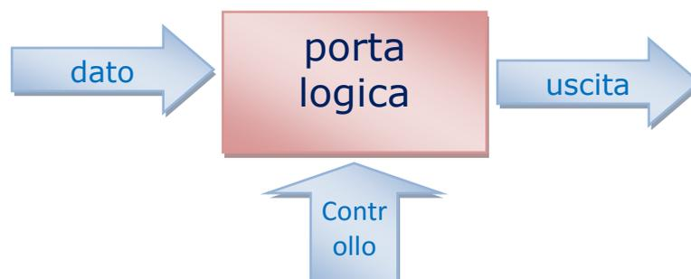
Le porte logiche a due ingressi possono funzionare in modalità **gating** se viene utilizzato un ingresso come **Dato** e l'altro come **Controllo**; l'uscita ha un comportamento che varia a seconda dei casi.
